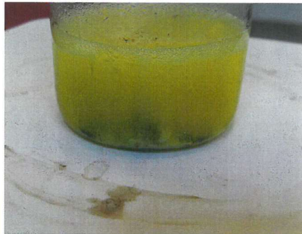
15 pav. Atskelto viršutinės dalies apdailinio teraco dangos paviršiaus fragmento tirpinimas 10% druskos rūgšties tirpale. a) – bandymo pradžia. b) – bandymo eiga. (vyksta reakcija – tirpimas).
