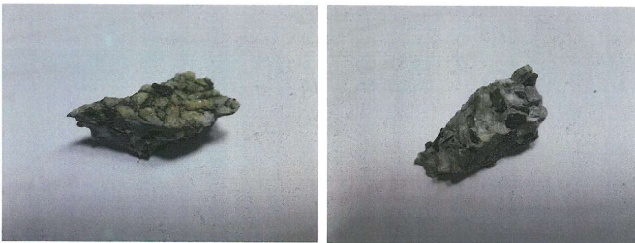
14 pav. Atskeltas viršutinės dalies apdailinio teraco dangos paviršiaus fragmentas, kurį sudaro balti ir juodi užpildai, bei mineralinis rišiklis
