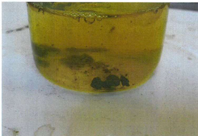
16 pav. Pasibaigus apdailinio teraco dangos fragmento reakcijai su druskos rūgštimi, liko nesureagavę tik juodi užpildai
